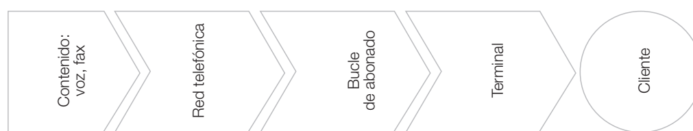
Figura 1. La cadena de valor de las telecomunicaciones antes de la liberalización del mercado
